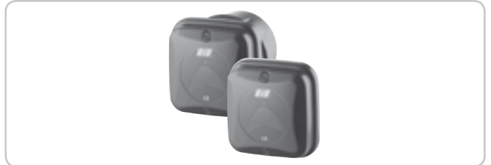
PHOTOCÉLULES MURALES FITSYNCRO code ACG8026 Portée cloisonnable 10+20 m. Plusieurs couples sont appliqués, rapprochés les uns des autres grâce au circuit synchronisé. Ajouter le TRANSMETTEUR SYNCRO code ACG8028 s'il existe plus de deux couples de photocellules (jusqu'à 4). COUPLE DE COFFRETS ENCASTRABLES POUR FITSYNCRO code ACG8051
