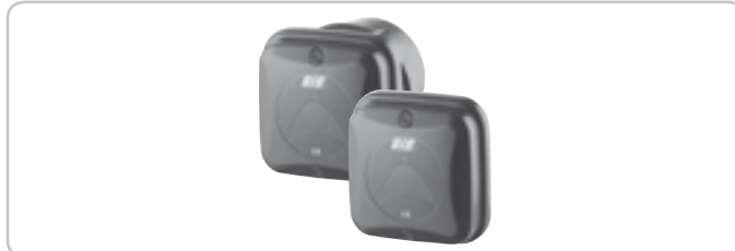
FOTOCELLE FIT SYNCRO DA PARETE cod. ACG8026 Portata settabile 10+20 m. Sono applicabili più coppie ravvicinate tra loro grazie al circuito sincronizzatore. Aggiungere il TRASMETTITORE SYNCRO cod. ACG8028 per più di 2 coppie di fotocelle (fino a 4). COPPIA DI CESTELLI DA INCASSO PER FIT SYNCRO cod. ACG8051
